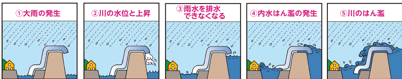
桂川と中河川の水位が上昇します。状況に応じて排水ポンプを運転し、桂川に雨水を排水します。
