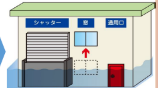
止水堰 かさ上げ 防水扉 浸水対策のイメージ
